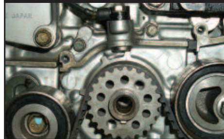
Imagen 4: Este sensor de posición del cigüeñal está ubicado por encima de un reluctor con una secuencia dentada distintiva.
